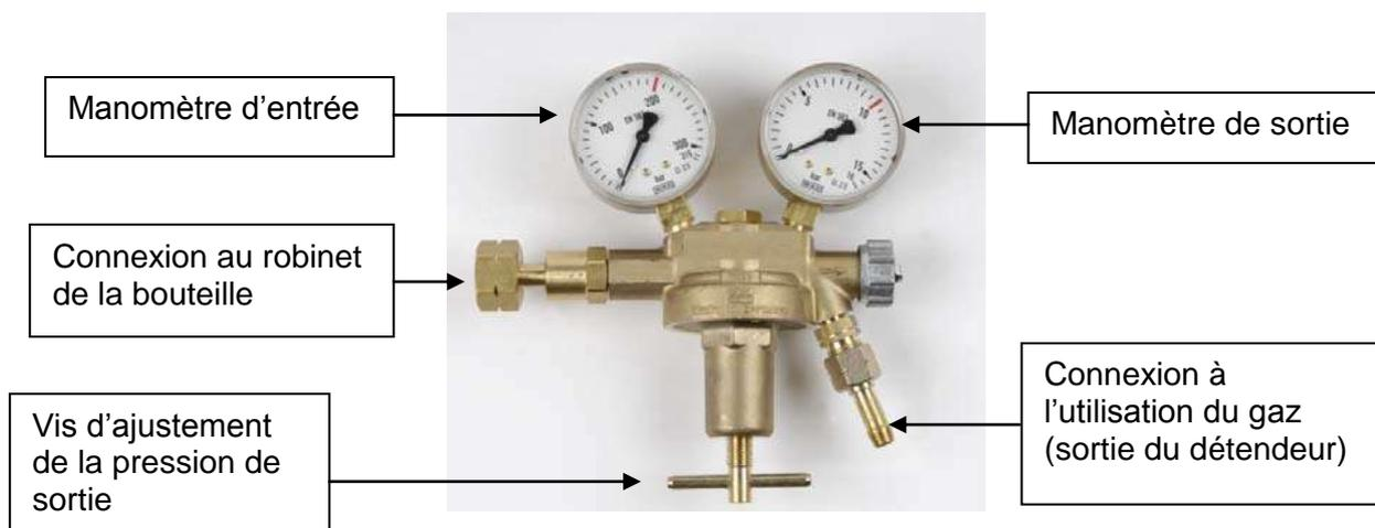
Les normes nationales et internationales définissent la conception et les tests requis pour les détendeurs y compris pour les détendeurs pour l'oxygène, par exemple la norme EN ISO 2503. Les détendeurs fabriqués selon cette norme fonctionneront en sécurité s'ils sont utilisés et entretenus selon les instructions des fournisseurs.
